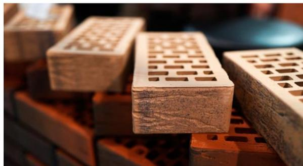
*Керамический клинкерный лего-кирпич может выдержать более 75 циклов заморозки и размораживания, а также противостоять химическим и механическим воздействиям, сообщает РИА Новости.*
